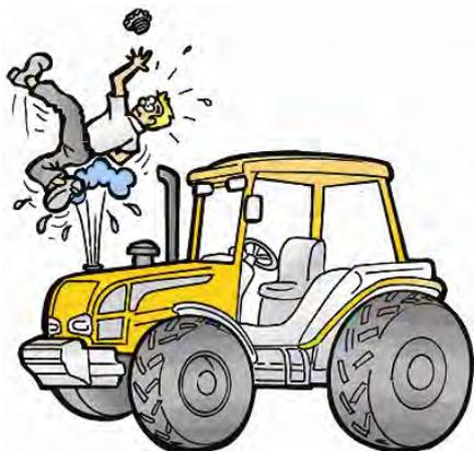
El líquido refrigerante del radiador podrá desbordarse en caso de funcionar bajo alta presión, si la tapa se quita en sólo un movimiento. Para quitar la tapa del radiador gírela hasta la primera posición, espere hasta aliviar la presión y luego, quítela.
