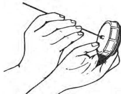
Verifique si el orificio del respiradero en la parte superior de la tapa está obstruido. De ser necesario, desobstruir con un alambre fino.
