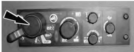
Girando el Selector de control de posición de los brazos de acoplamiento (flecha) hacia arriba (sentido horario), los brazos inferiores de acoplamiento se levantan y se posicionan a la altura especificada.
