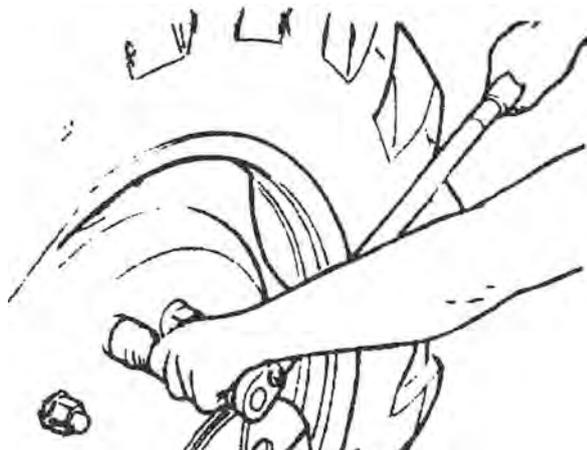
Verifique el apriete de las tuercas de las ruedas traseras y delanteras utilizando un torquímetro.
