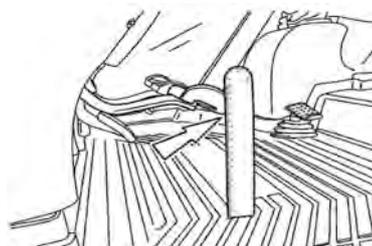
Con el pedal del embrague en reposo mida la distancia del piso hasta un punto de referencia en el pedal.
