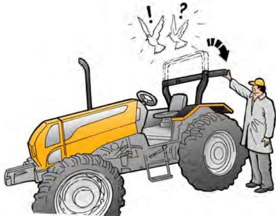
Si el ROPS/EPC instalado es del tipo articulado, asegúrese de que esté en su posición extendida y firmemente bloqueada.
