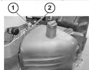
Remueva la tapa de la tobera de relleno del aceite hidráulico (1) y abastezca el tanque con aceite nuevo (consulte la tabla de lubricantes). Verifique el nivel del aceite hidráulico a través de la varilla de medición (2).
