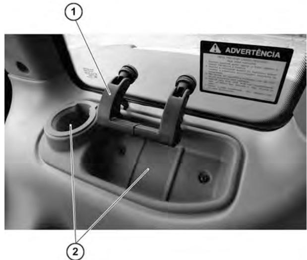
Tire de la manija (1) hacia arriba y empuje la ventana hacia afuera. Las ventanas laterales tienen sólo una posición de apertura.
