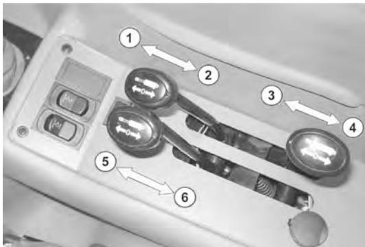
Cuando la palanca es accionada en las posiciones (1 y 2), el sistema se presuriza en las salidas del control remoto (1 y 2).
