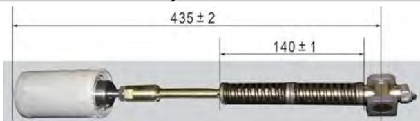
Ajuste del sistema electro hidráulico. Garantizar que el sistema interno esté totalmente desacoplado. Suelte la palanca (1) y ajuste el vástago (2) según las medidas descritas. Apriete nuevamente la palanca (1) en su eje de articulación
