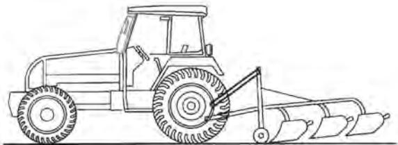
3. Una altura de elevación exagerada en la parte trasera del implemento puede deberse a que el tercer punto esté conectado demasiado abajo en el Tractor y muy arriba en el implemento.
