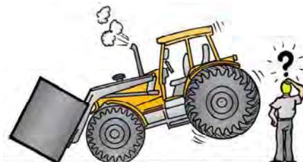
Cuando utilice un cargador frontal, no deje que nadie permanezca cerca del área de trabajo, existe el riesgo de que el Tractor vuelque cuando la carga sea elevada. El operador deberá dejar el cargador al nivel del suelo antes de estacionar el Tractor. Las instrucciones provistas por el fabricante también deben ser cumplidas para evitar accidentes.
