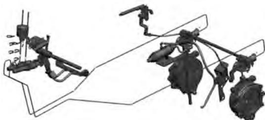
Los frenos de servicio son accionados mecánicamente a través de los pedales y son del tipo multidisco bañado en aceite. Los discos de freno
