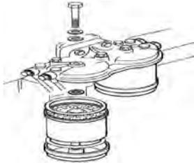
Remueva los tornillo de fijación, elementos filtrantes, anillos "O" y juntas de sellado.
