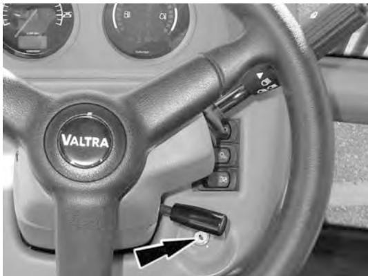
**Posición 1:** Circuito eléctrico encendido (luces de los instrumentos encendidas)
