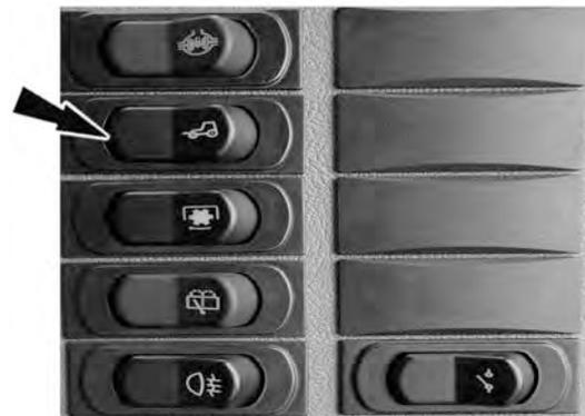
Para acoplar la tracción delantera, detenga el Tractor y accione la tecla (flecha) en la consola del lado derecho de la cabina. La indicación de accionamiento de la tracción aparece en el tablero.
