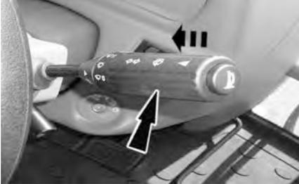
Para eyectar agua y limpiar el parabrisas, accione la manopla de la palanca del switch en el sentido indicado por la flecha.
