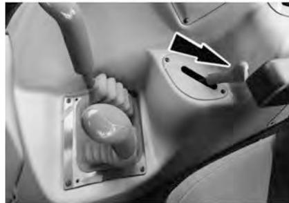
Palanca accionada hacia atrás, el motor gira en marcha lenta y así que se desplaza hacia adelante, la rotación aumenta.
