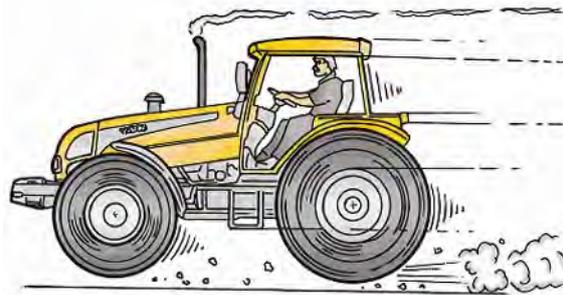
Adapte la velocidad del Tractor de acuerdo a la superficie a recorrer, así como también a las condiciones de visibilidad y la carga a transportar. Evite frenadas o el aumento brusco de la velocidad de funcionamiento, así como hacer curvas cerradas a alta velocidad. Esto podrá provocar el vuelco de la carga o del Tractor.
