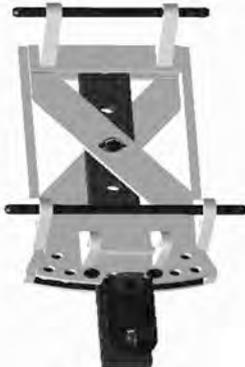
La barra de tracción de tipo oscilante, puede trabajar libremente o fijada lateralmente a ambos lados del lugar en donde las fuerzas permanecen estables.
