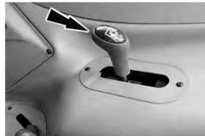
Apague la TDF utilizando la tecla ubicada en el consola del lado derecho de la cabina, antes de cambiar las rotaciones.
