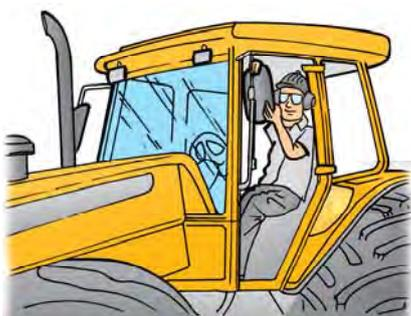
Verifique antes de conducir o transitar por las rutas, las condiciones de seguridad del Tractor. Los espejos retrovisores deben estar debidamente ajustados a fin de ofrecer un ángulo de visión correcto antes de comenzar su marcha.
