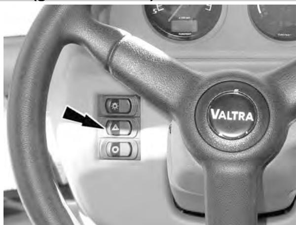
Para encender las luces de aviso accione la tecla indicada y para apagarlas acciÓnela nuevamente.
