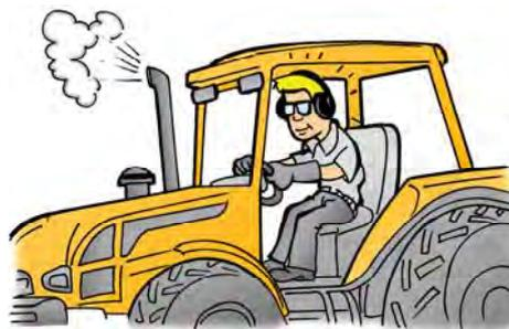
El funcionamiento con este Tractor, en condiciones de carga parcial o total, expone al operador a un nivel de ruido continuo e intermitente, superior a 85 db. (A), medido según el procedimiento de la Norma ABNT NBR 9999.
