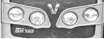
Encienda los faroles en luz baja e inspeccione si el ajuste de las señales es correcta.
