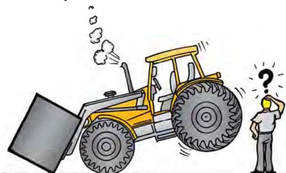
Cuando transite por una ruta, por lo menos 20% del peso bruto del Tractor debe estar apoyado en el eje delantero, a fin de garantizar la estabilidad de la dirección. Se debe utilizar un número suficiente de contrapesos. Éstos deben ser montados solamente en los lugares designados para este fin.
