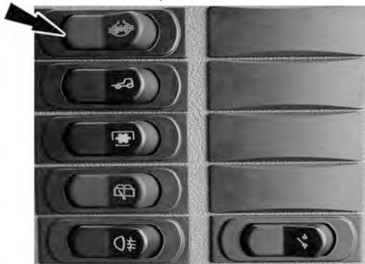
Para acoplar y desacoplar el bloqueo del diferencial, detenga el Tractor y accione la tecla (flecha).
