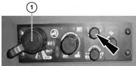
1. Selector de control de posición de los brazos de acoplamiento
