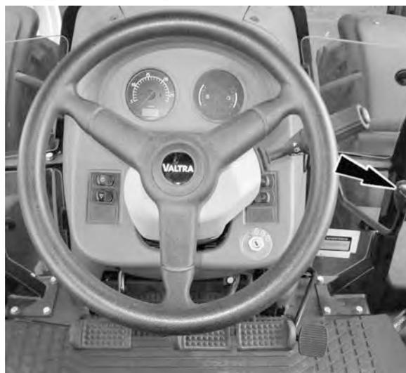
Con la palanca accionada (flecha) hacia abajo, el motor gira en marcha lenta y así que se desplaza hacia arriba, la rotación aumenta.
