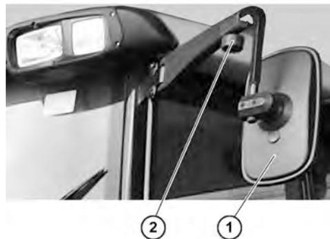
Los retrovisores externos pueden ajustarse. En caso de ser necesario ajustar su posicionamiento, proceda de la siguiente manera:
