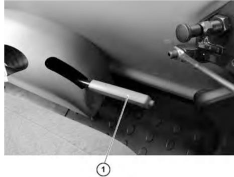
1. Palanca del freno de mano (con función de navegación en el tablero)
