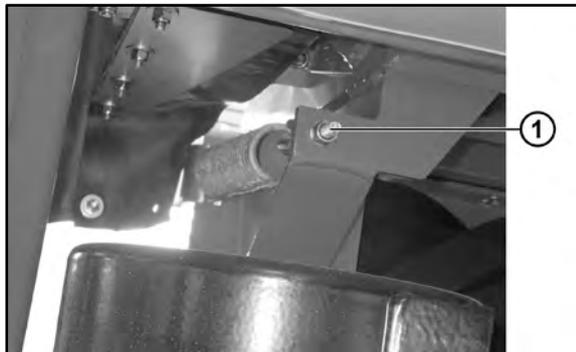
Abb. 34 Ajuste de la tensión elástica, derecha
