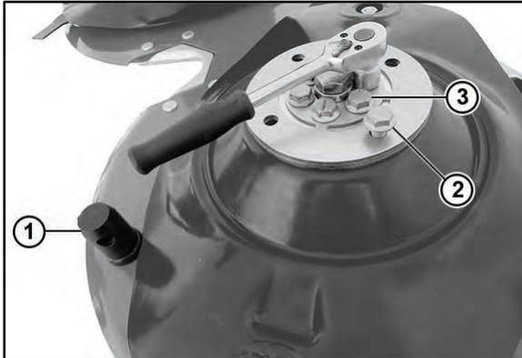
Abb. 48 Apriete de los tornillos interiores
