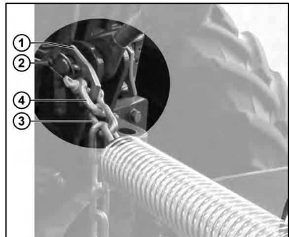
Abb. 19 Descarga por muelle fijada en el brazo superior
