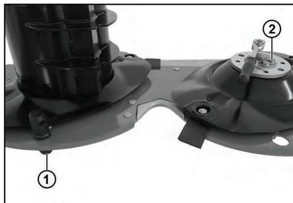
Abb. 45 Aflojamiento de los tornillos interiores
