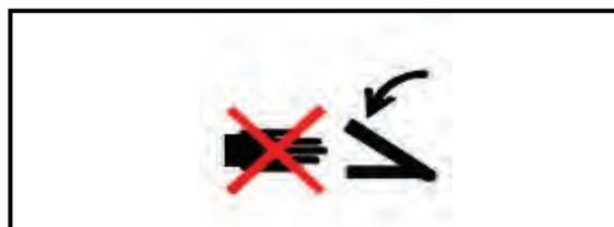
Fig. 76 Existe peligro de aplastamiento - No introducir las manos en la zona de las partes móviles
