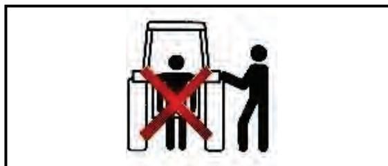
Fig. 44 La estancia entre el tractor y la máquina durante el acoplamiento está prohibida
