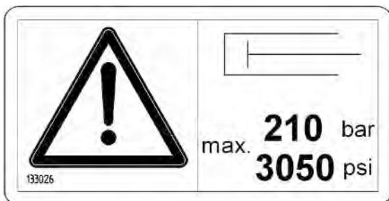
Fig. 35 Máxima presión hidráulica admisible
