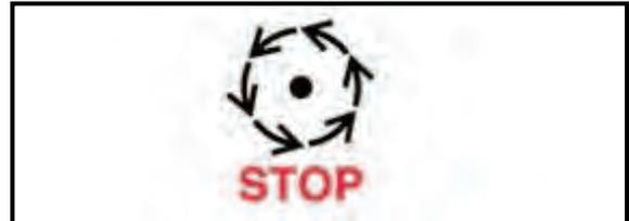
Fig. 134 Esperar hasta que haya transcurrido el tiempo de inercia o se haya producido la parada
