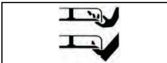
Fig. 66 Peligro de sufrir lesiones debido a discos segadores en rotación - Mantener la distancia
