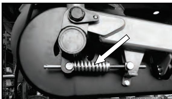
Fig. 93 Resorte tensor para tensar las correas trapezoidales
